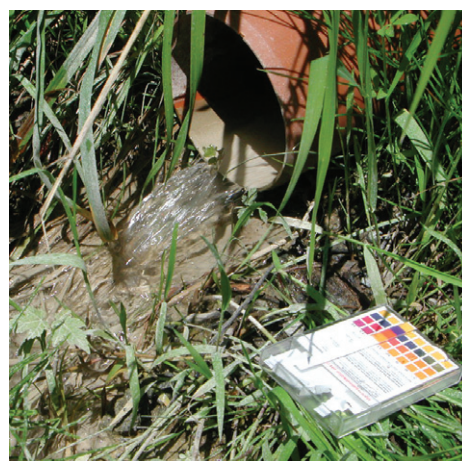
Bandelettes utilisées pour le contrôle rapide du pH d'un effluent.
